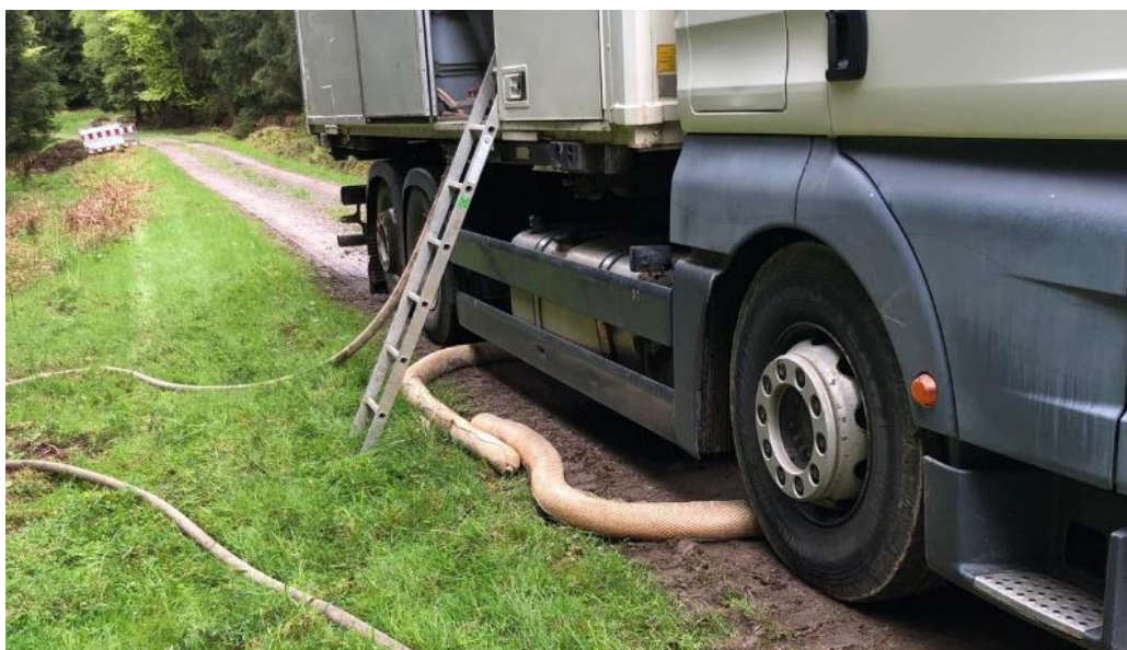
Abbildung 9: Empfohlene Maßnahme: Vorsorgliche Auslage von Sorbschlängeln unter Tanks, z.B. von Baufahrzeugen, wenn sie länger stehen
